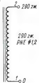
Rys. 5. Diodek D1 Blacha krzemowa \pm 0,35 mm, przekrój rdzenia ok. 12 cm 2 , przekrój okna ok. 12 cm 2 . Rdzeń układać tak, aby wystąpiła szczelina \pm 2 mm. Szczelinę wypełnić przekładką \pm 2 mm
